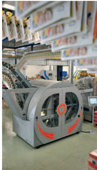
Mit der Ferag-Einsteckanlage EasySert im Druckzentrum der Mediengruppe Pressedruck in Augsburg können knapp 800.000 Prospekte in der Stunde verarbeitet werden.
